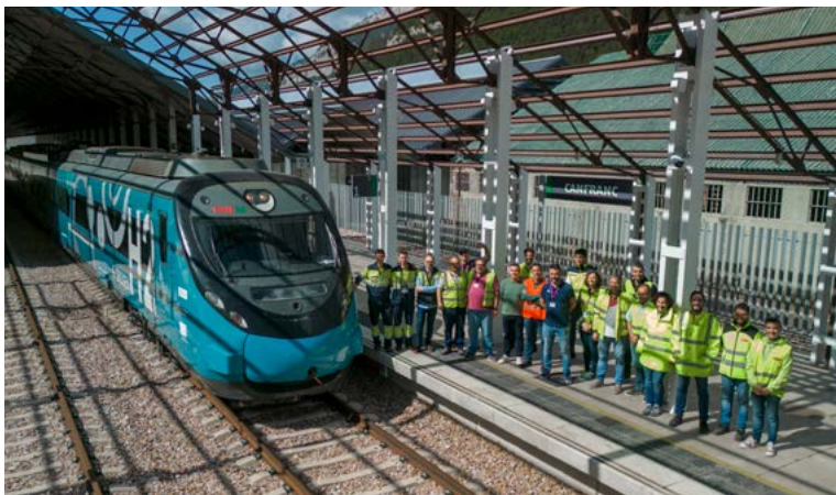
Tren de hidrógeno en Canfranc con tres tipos de tracción (hidrógeno, baterías y eléctrica por pantógrafo)
