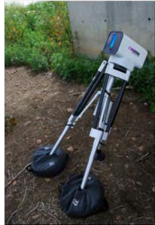
Ensayos en el Viaducto de La Marota con el LIDAR láser de OMMATIDIA
