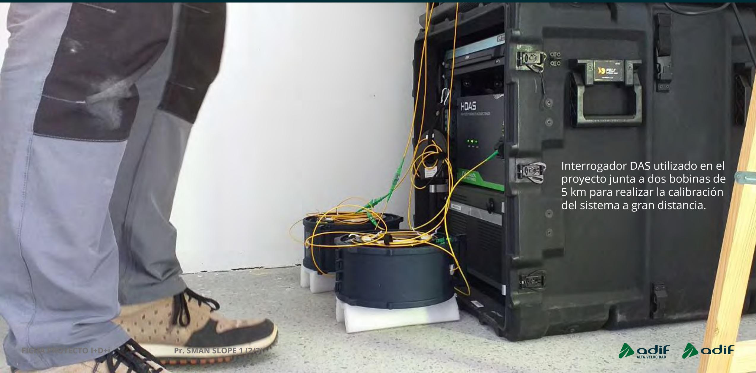
Interrogador DAS utilizado en el proyecto junto a dos bobinas de 5 km para realizar la calibración del sistema a gran distancia.
