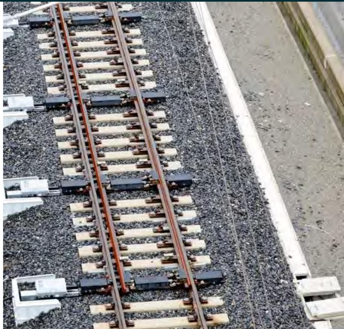
Pruebas en la base de Mantenimiento de AV de Olmedo del sistema de auscultación ultrasónica. Junio 2022
