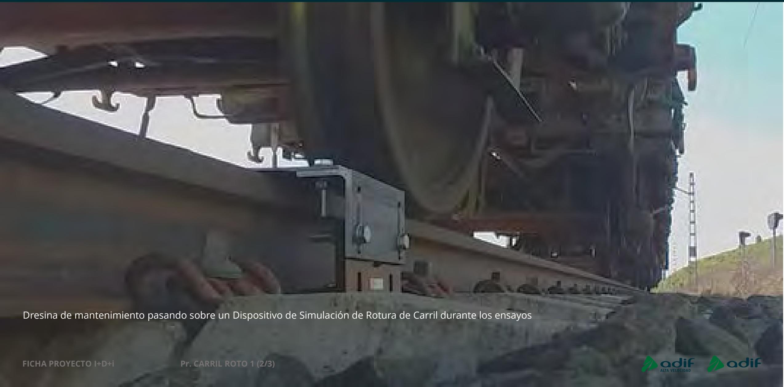
Dresina de mantenimiento pasando sobre un Dispositivo de Simulación de Rotura de Carril durante los ensayos
