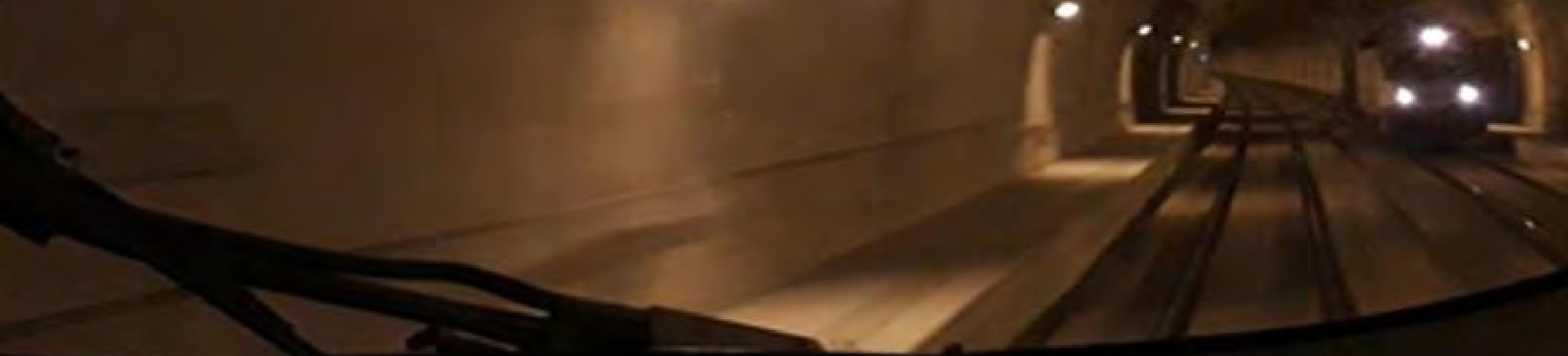
Imagen del momento de cruce de un tren de pruebas S-103 con una locomotora 252 con un vagón con un contenedor instrumentado para la medida de la presión generada en el cruce en un túnel. LAV Madrid-Barcelona-Figueras. Ensayos a escala real para la calibración del modelo de presiones generadas y comportamiento dinámico
