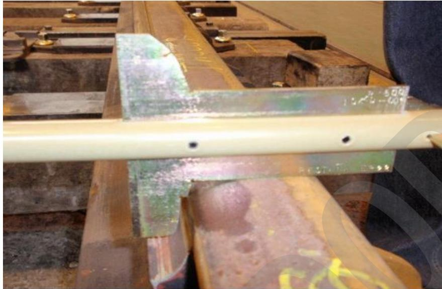
Fotografía 104. Rueda acuchillada (para desvíos instalados en curva) en la PA e introducción del calibre.
