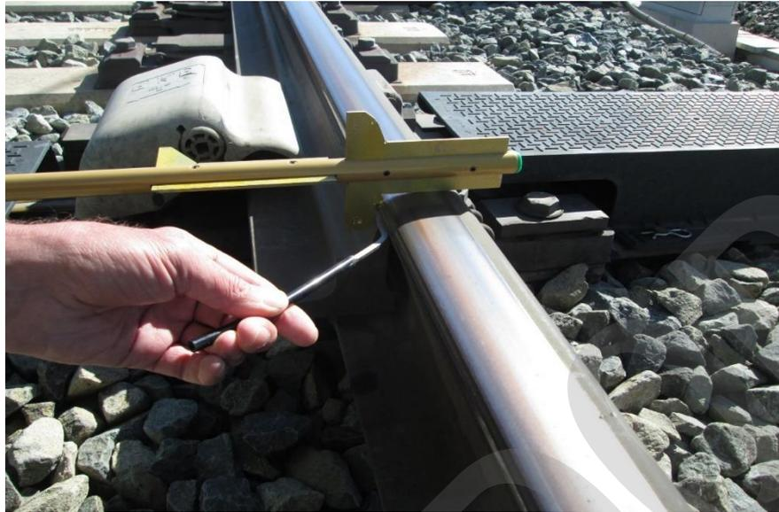
Fotografía 109. Rueda acuchillada (desvíos instalados en recta o curvas con  $R \geq 1500$  m) en la PA e introducción del calibre, en un desvío tipo AV1.
