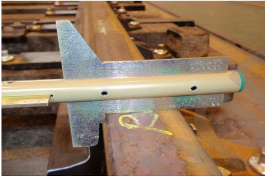
Fotografía 105. Rueda acuchillada, plantilla nº 12 (para desvíos instalados en recta o curvas con  $R \geq 1500m$ ) a 5 cm de la PA.
