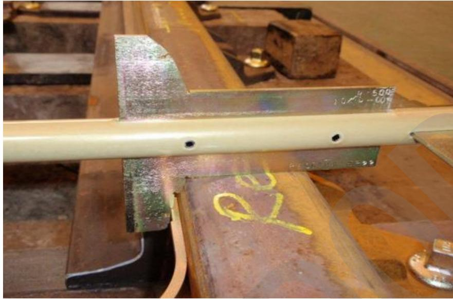
*Fotografía 102. Rueda acuchillada (para desvíos instalados en curva) a 5 cm de la PA introduciendo el calibre.*
