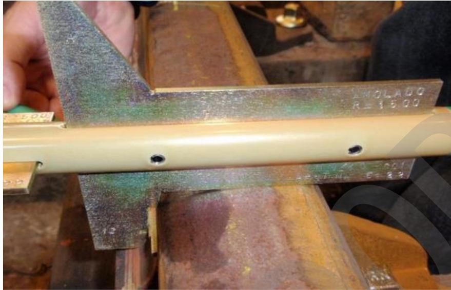
Fotografía 107. Rueda acuchillada (desvíos instalados en recta o curvas con  $R \geq 1500m$ ) en la PA e introducción del calibre.
