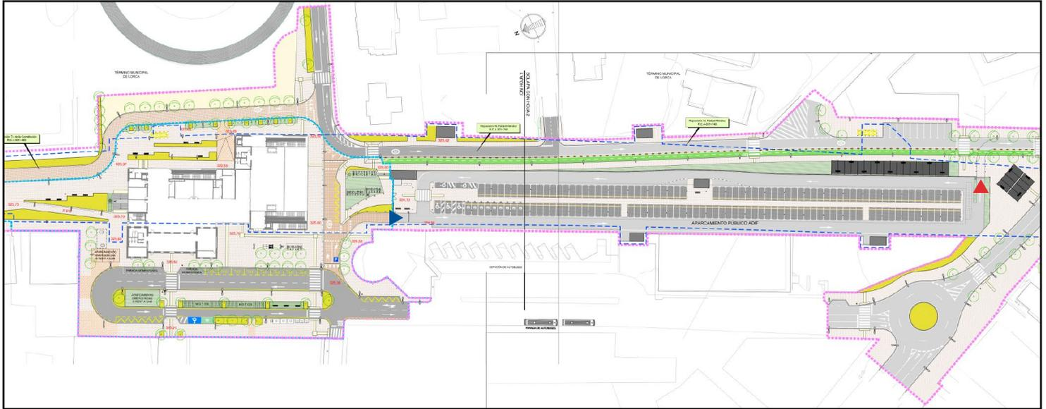
En cumplimiento de los requisitos del programa de necesidades se proyecta la construcción de un aparcamiento público en superficie, situado sobre la cubierta del cajón ferroviario, al sur del edificio de viajeros, entre la estación de autobuses y la Alameda de Rafael Méndez.
