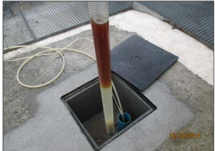
Comprobación de producto libre en piezómetro utilizando un bailer
