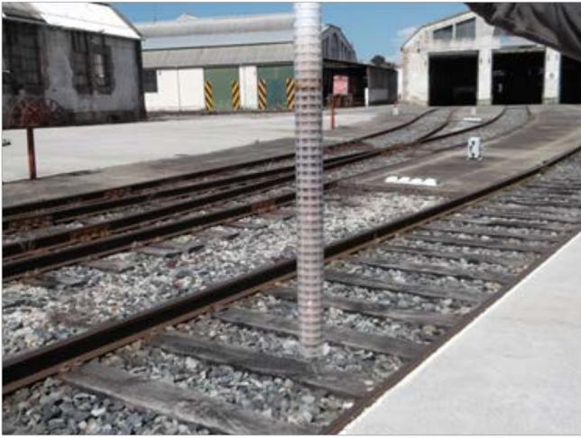
Absorbente para piezómetro de dos pulgadas
