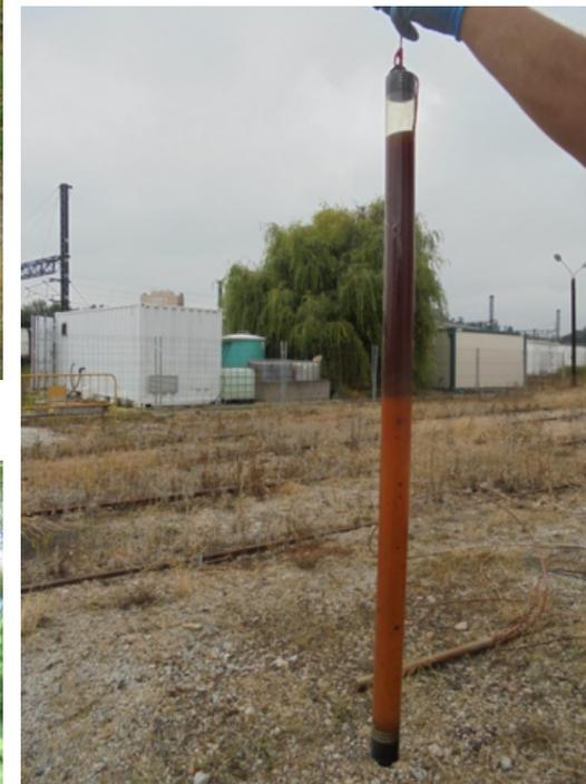
Comprobación de producto libre en piezómetro utilizando un bailer
