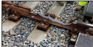
**CARRIL ROTO.** Identificación y ensayos con tecnologías que detecten la rotura de carril
