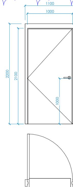
P\_17 Puerta exterior abisagrada panelada de una hoja sistema CORTIZO MILLENIUM PLUS o equivalente, de dimensiones 2200x1000 mm (de luz y altura de paso), con premarco compuesto por perfiles tsac de aleación de aluminio 6063 con tratamiento térmico T-5 y estanqueidad con juntas de EPDM de alta calidad y tornillería de acero inoxidable con acabado lacado gris RAL 7012. 1
