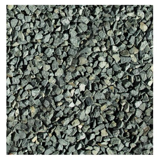
El consumo de materiales se reduce principalmente al uso de balasto (93%), seguido de las traviesas de hormigón, que suponen un 5% del consumo total de materiales.
