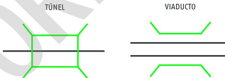
Figura 25. Representación de túnel o viaducto.
