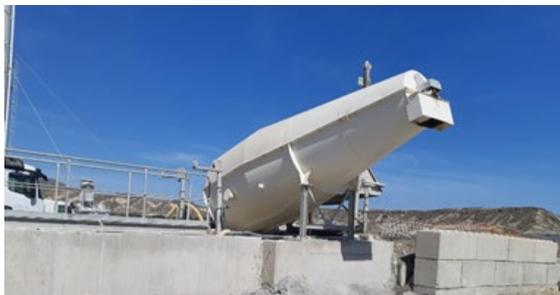
Figura 7. Recicladora en Planta de hormigón Pulpí-Vera
