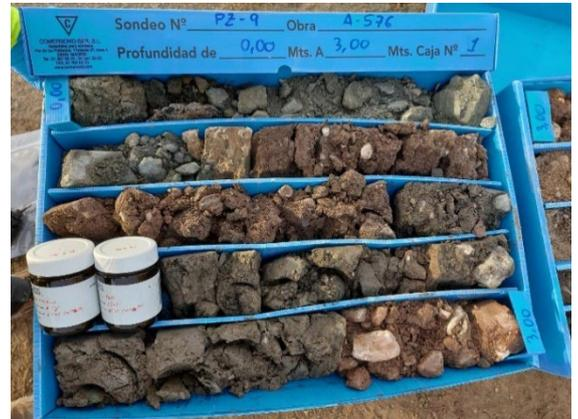
Figura 14. Cajas de testigos de perforación
