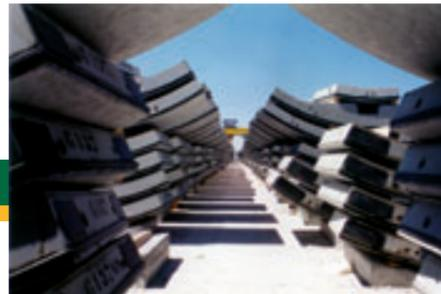
En las juntas radiales se ha dispuesto un suplemento de armaduras de  $8 \text{ } \varnothing \text{ } 8$  en la dirección mayor y  $8 \text{ } \varnothing \text{ } 6$  en la dirección menor. Además se ha dispuesto un refuerzo de armadura en el contorno del alojamiento de los tornillos y del punto de elevación de la dovela.
