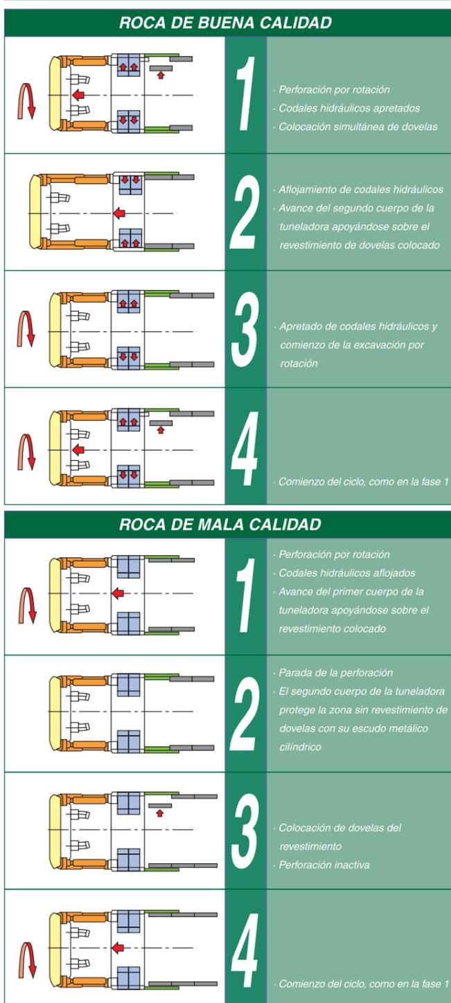
el escudo trasero. Hecho esto, se recogen los codales hidráulicos y el equipo de escudo desplaza la máquina a la posición de inicio de un nuevo ciclo. Con ello se logran los ritmos máximos posibles de avance.
