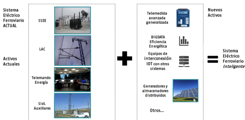
Esquema general de una red de tracción ferroviaria inteligente (partiendo de la red actual).
